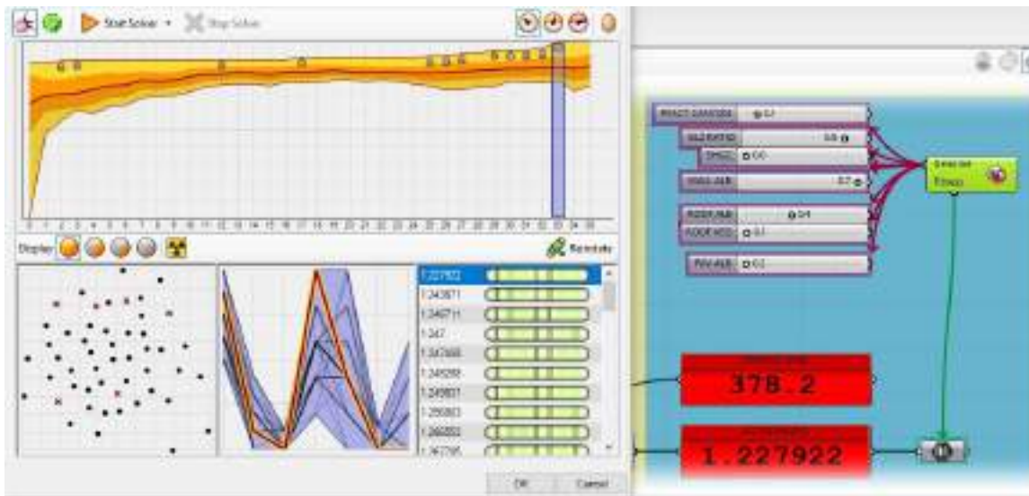
Figura 177 - Interfaz del módulo Galápagos Evolutionary Solver integrado en Grasshopper . Fuente: elaboración propia.
