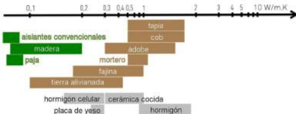
Figura 63 - Rangos de valores de conductividad térmica de distintas técnicas constructivas con tierra y materiales convencionales. Fuente: Traducido de Amaco, 2016.
